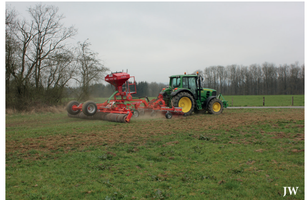
Behebung oberflchlicher Schden mit Hilfe eines Kombi-Gertes aus Egge/Walze/Smaschine
