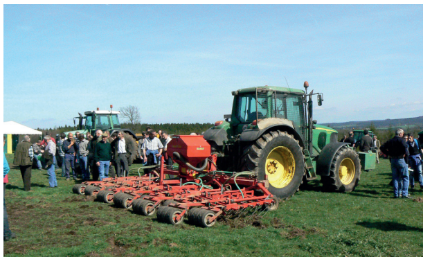
Striegelegge mit kleinen Walzen und Sämaschine
