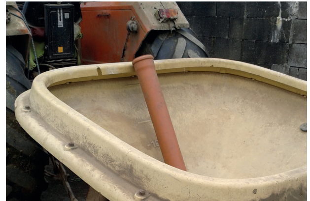
„Hausgemachtes“ System: PVC-Rohr, mit dem Saatgut und Dünger getrennt wird
