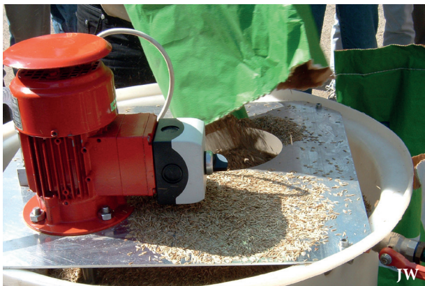
Güllefass-System: Mischung von Grassamen in einem mit Wasser befüllten Behälter
