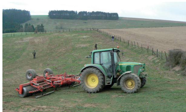
Striegelegge mit Planierschiene und großen Walzen
