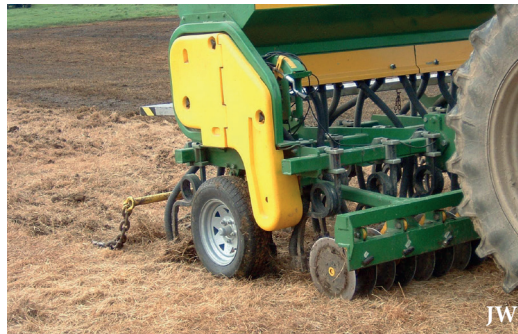
Die Scheiben der spezifischen Sämaschine ziehen Furchen in den Boden
